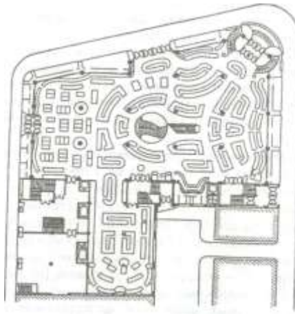
Рис. 1 Пример расстановки оборудования в торговом зале
