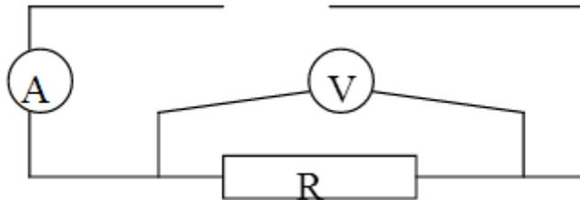
2.Проверьте схему у преподавателя или лаборанта.3.Включите цепь и, установив ток, запишите значения тока и напряжения в таблицу
